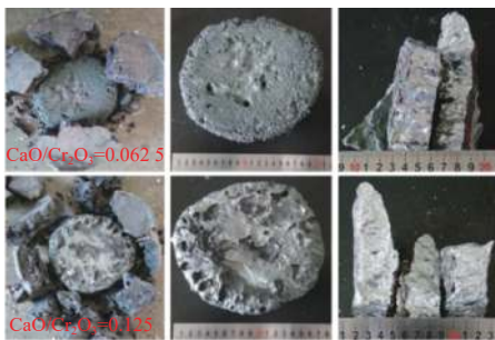
图 7 \text{CaO}/\text{Cr}_2\text{O}_3 分别为 0.062 5 和 0.125 时的冶炼情况 Fig. 7 Smelt products with \text{CaO}/\text{Cr}_2\text{O}_3=0.062 5 and 0.125
