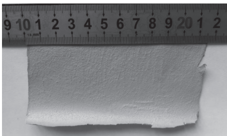
图3 原始五氧化二钒纳米纤维无纺布的宏观形貌 Fig.3 The digital photo of original V 2 O 5 nanowire nonwoven
