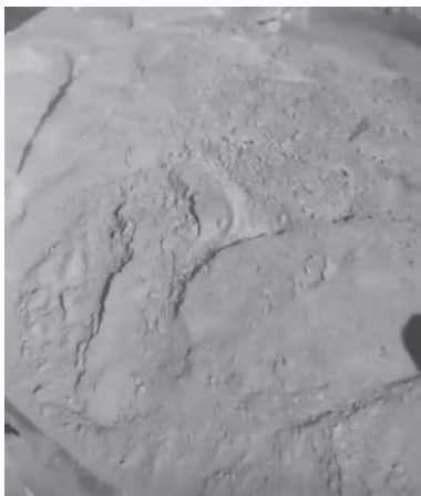
图 7 四氯化钛泥浆蒸发得到固体粉末样品
