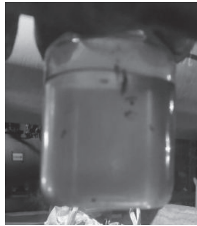
图 8 泥浆蒸发回收得到四氯化钛样品
