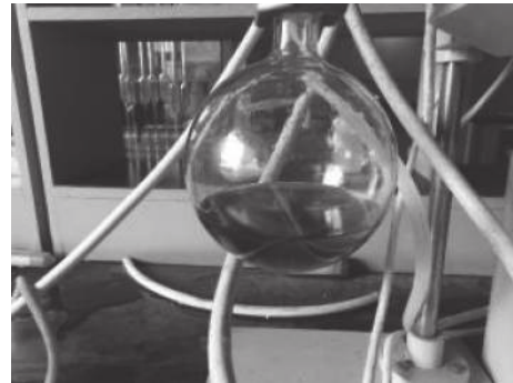
图 4 真空蒸发试验清液分离效果
