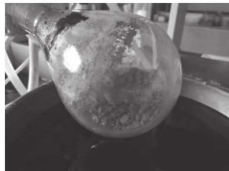
图 5 真空蒸发试验固体颗粒分离效果
