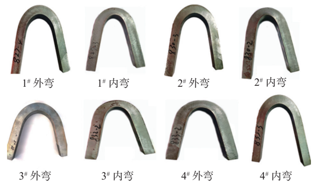
图 3 钛/钢复合板的弯曲性能
